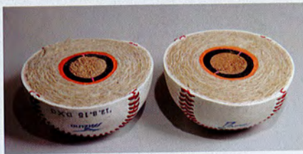
統一球の断面。中央のコルク芯を黒とオレンジのゴム材が覆っている。今年の統一球は、このゴム材の低反発素材の配合が少なくなっており、反発係数が高まっている
