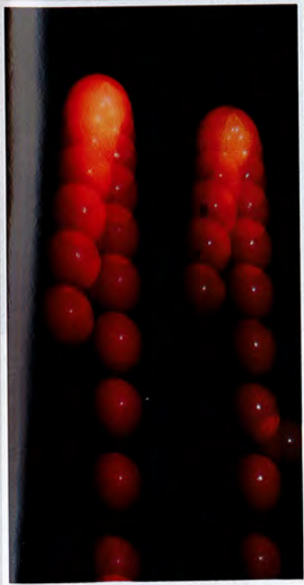
新旧統一球のゴム材に覆われた中央部分を同じ高さから落とすと、今年統一球の方(左)がより高く弾んだ
