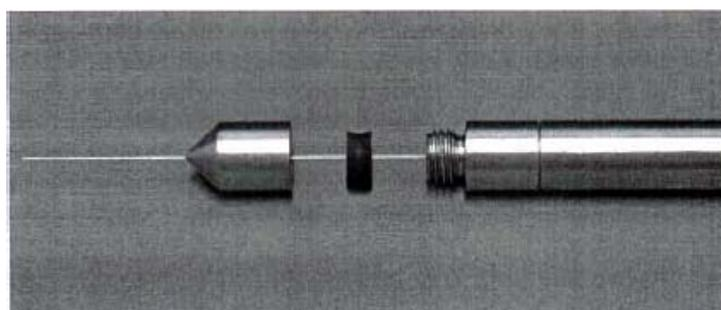
図 9： グラスファイバ先端を固定するために用いられるグラスファイバホルダの詳細
