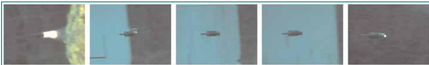
飛しょう体の飛しょう特性を正しく評価するために、弾道の飛しょう性能を光学的に観測することは必要です。これを多数のシングルショットカメラで行うとすればたくさんのカメラを必要とし非常に高価な装置になります。飛しょう体追尾観測装置は、高速で回転するスキャン鏡と高速ビデオカメラを使用することで飛行における、飛しょう体の連続的で正確な追跡を提供するために開発されました。この装置は 100m 以上にわたり飛しょう体の飛翔状況を観測します。Specialised Imaging (英国) 社製光学式飛しょう体追尾観測装置はトラッキングヘッド、ミラー、制御回路および耐久性ラップトップ制御コンピュータから成ります。
