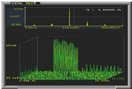
FFT/モデル分析 (たとえば 4096) およびデシマル (たとえば 5000) サンプルレートおよび掃引長さの選択が可能です。
