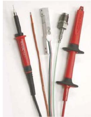
DC ブリッジ：ストレーンゲージ、ロードセル、力、圧力、トルク、ピエゾ-抵抗などのセンサーを 1/4、1/2 およびフルブリッジを使って接続してください。自動バランス、シャント計算、自動計算機能がボタン 1 つで可能です。
