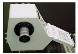
レンズインテンシファイアは、様々なタイプの高速カメラの感度を改善するために開発された、ゲート式イメージインテンシファイアです。様々なトリガー機能により、ほとんどのメーカーの高速度カメラと容易に接続することが可能です。特にハイゲインの MCP インテンシファイアの採用により、画像用途でのほとんどの要求を、広範囲の波長感度特性、ハイゲインおよび高解像度で満たすことが可能です。キーパッドによる簡易な操作が行え、標準のイーサネットにより PC からの遠隔制御も可能です。インテンシファイアの光電面は UV の範囲内の感度を最適化するように選択することもできます。インテンシファイアへの画像入力は、標準レンズマウント(ユーザ要求による、C マウントあるいはニコン F マウント)で提供されます。撮影された画像は、標準マウントのニコン F-マウントによりカメラに接続されます。
