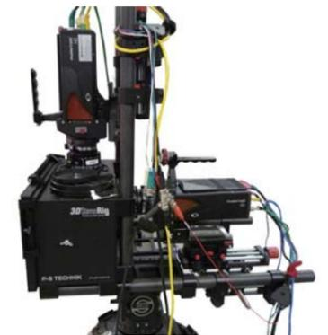
ハーフミラー式リグを使用し、Phantom2台を完全同期させて行う3Dハイスピード撮影システムです。3D撮影に必要な周辺機器からオペレーションまでトータルシステムのご提案が可能です。驚きの3Dスローモーション映像を撮影することが出来ます。
