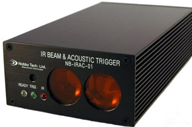
IRビーム&アコースティックトリガー装置は、あなたのカメラの目や耳の役割をすることにより、高速度カメラのトリガーに関する問題を解決します。ビデオビームは赤外線ビームを遮る事で「接点」、「離点」信号を供給でき、あるいは音響によってトリガーを出力することも可能です。この2つの機能が同じ小さな筐体に組み込まれています。また、レーザーを使用しておりませんので、使用上も安全です。
